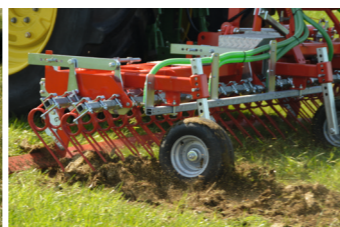
Même en conditions difficiles, les dents de 12mm travaillent efficacement.
