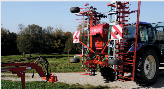
Le rouleau est équipé d'un couplage rapide.
