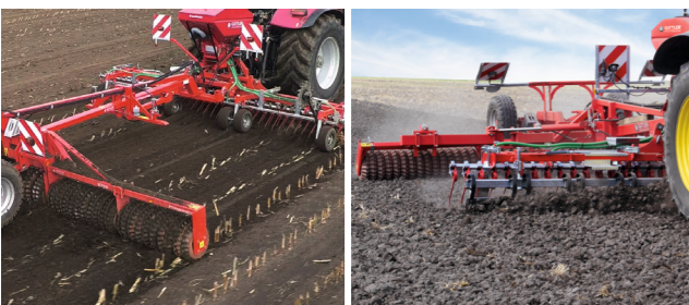
Lutte contre la pyrale du maïs avec semis simultané d'une culture d'hiver
