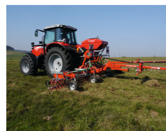
Semoir pneumatique Il distribue les semences avec précisions au plus près du sol.
