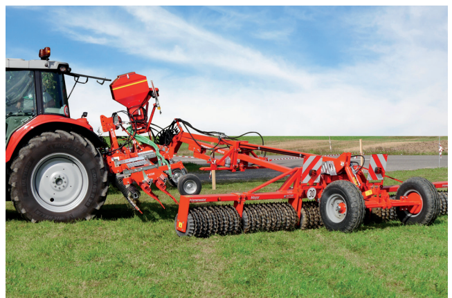
Die Walze wendet nicht auf dem Fahrwerk, sondern auf den Walzensternen – enges Drehen, kein Aufschaukeln.
