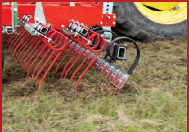
Das Ripperboard verdoppelt die Zinkenanzahl des GreenSeeder.
