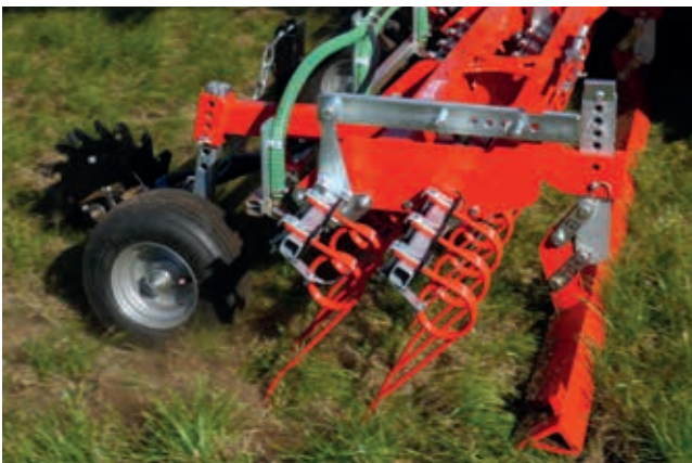
Einebnungsschiene mit Parallelogramm-Führung.
