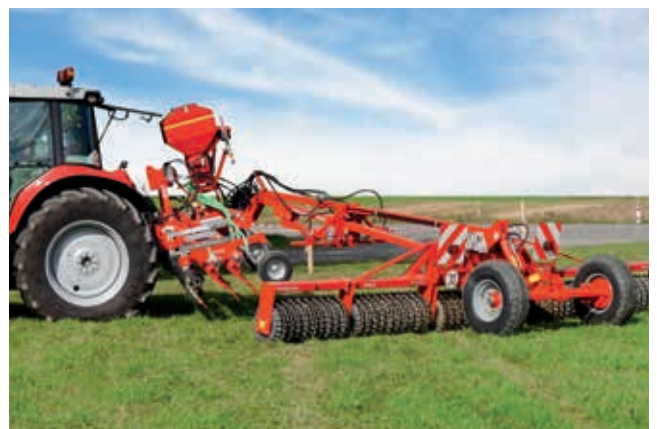
Die Walze wendet nicht auf dem Fahrwerk, sondern auf den Walzensternen – enges Drehen, kein Aufschaukeln.
