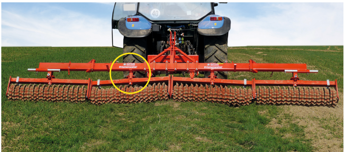
Mediana 600 - Vier pendelnde Walzensektionen, unübertroffene Boden Anpassung.
