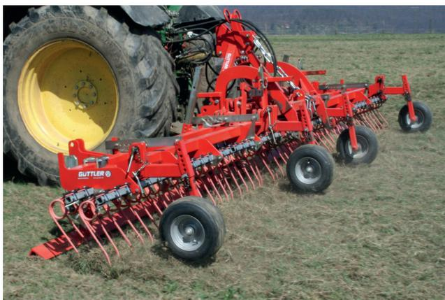
Frontstützräder abnehmen – HarroFlex im Heck einsetzen
