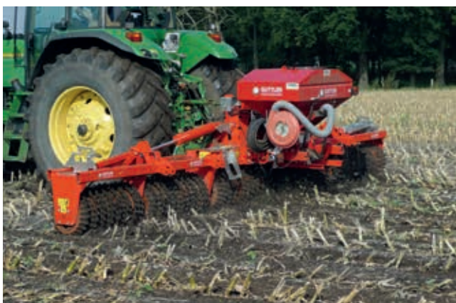
Die Matador 610 bricht und quetscht die Maisstoppeln.
