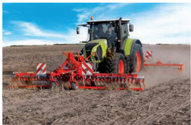
Die Einebnungsschiene legt die Maisstoppel in Fahrtrichtung um.
