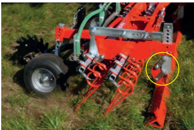
Einebnungsschiene mit Parallelogramm-Führung
