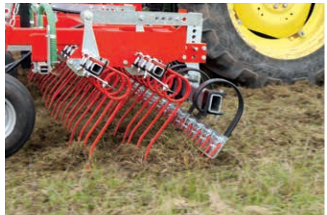
Ripperboard verdoppelt die Anzahl der Zinken im Boden, steigert die Effektivität beim Auskämmen von Gemeiner Rispe und anderem Filz.
