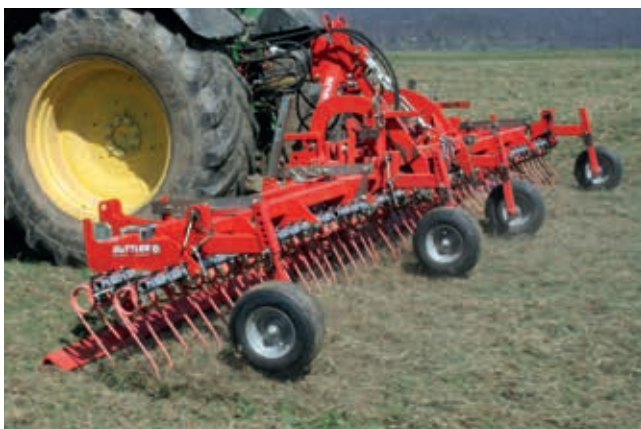
Frontstützräder abnehmen - HarroFlex im Heck einsetzen
