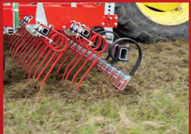
Das Ripperboard verdoppelt die Zinkenanzahl des HarroFlex.
