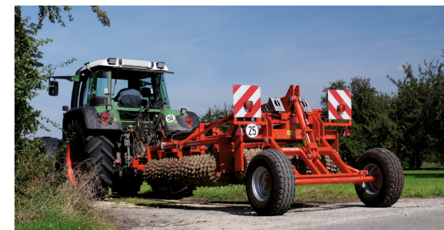
Sicher auf der Strasse: Transportbreite 2,40 m, niedriger Schwerpunkt.
