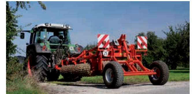
Sicher auf der Strasse: Transportbreite 2,40 m, niedriger Schwerpunkt.
