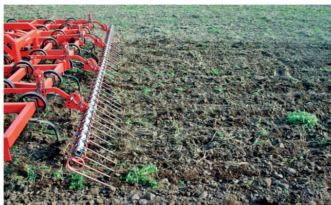
Die Super Maxx® Zinken lösen den Bewuchs. Der Striegel legt das Unkraut an der Oberfläche ab, wo es vertrocknet.
