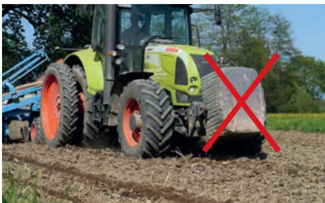
Toter Frontballast – kopflastiger Schlepper: Bodenverdichtungen durch die stark belastete Vorderachse.
