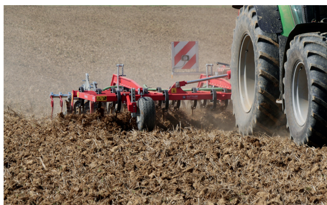
Zur Unkrautbekämpfung können Stützräder vorne hilfreich ein, um Druck von der RollFix-Walze zu nehmen.
