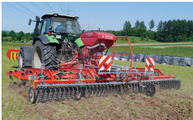
Die hochfrequent vibrierenden Zinken arbeiten in hartem Boden wie ein Pressluftschlämmer.
