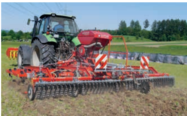
Die hochfrequent vibrierenden Zinken arbeiten in hartem Boden wie ein Presslufthammer.
