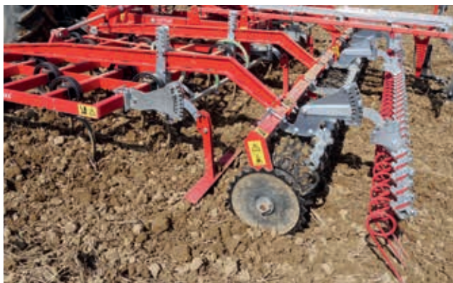
Option: Striegel nach der Walze zur mechanischen Unkrautbekämpfung.
