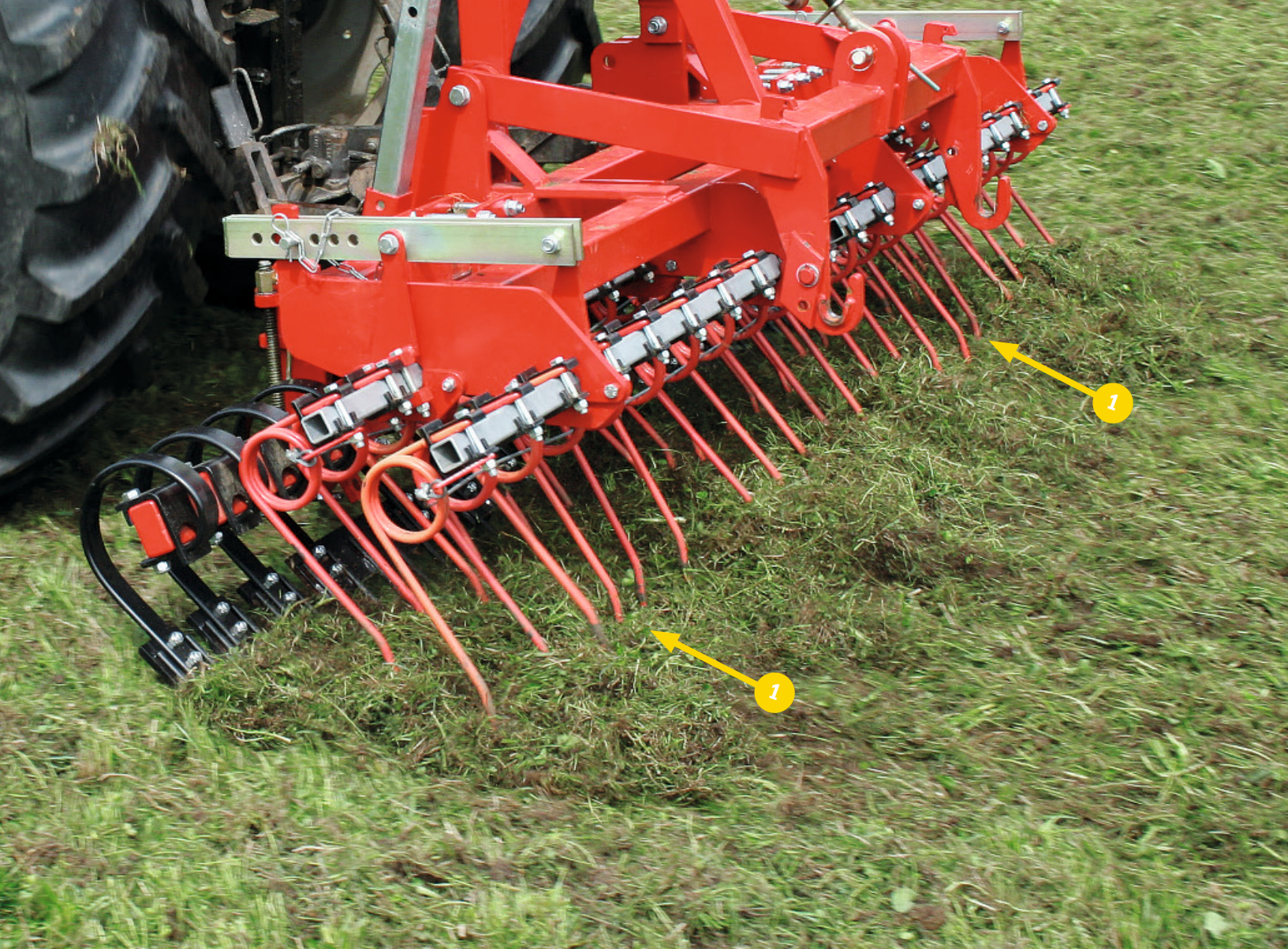
1 Langhubige Striegelzinken tasten Unebenheiten feinfühlig aus.
