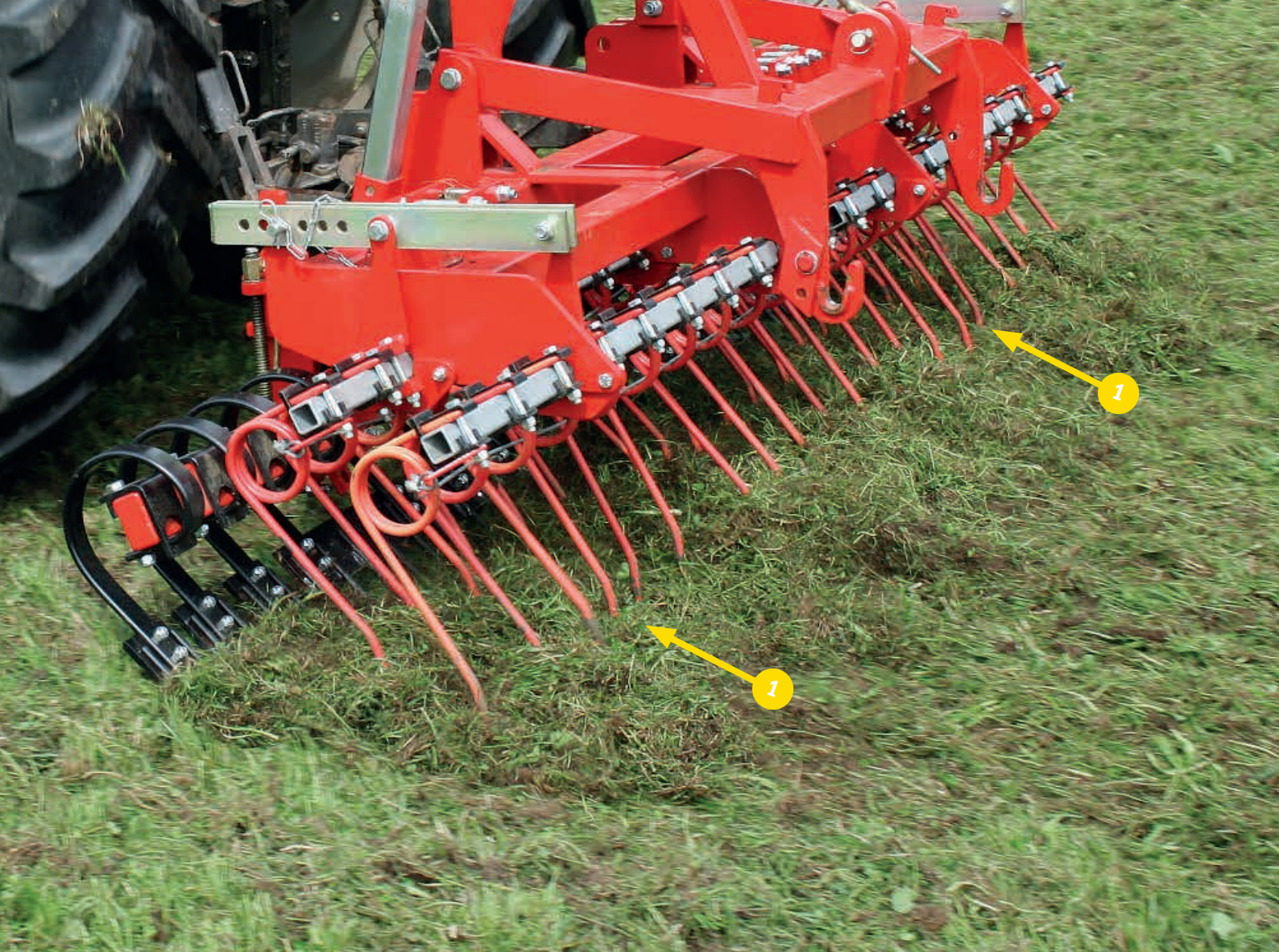
1 Langhubige Striegelzinken tasten Unebenheiten feinfühlig aus.
