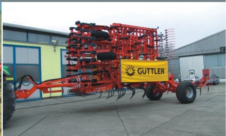
Der SuperMaxx® mit einer Arbeitsbreite von 10 und 12 Metern erbringt auf allen Böden eine hervorragende Flächenleistung, egal ob es um Stoppelbearbeitung, Einarbeiten von Gülle oder um Saatbettbereitung geht.
