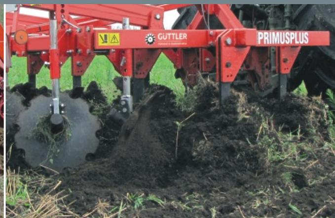
Wenige kräftige Zinken reißen grosse Kluten aus dem Boden. Dies und die grössere Arbeitstiefe kosten Energie. Merke: 1 cm tieferes Bearbeiten bedeutet, daß Sie pro Hektar 150 Tonnen Boden (= 7 grosse LKW voll) bewegen! Das Zerkleinern und Rückfestigen der so entstandenen groben Kluten fordert weiteren Energieeinsatz. Es ist auch aus diesem Grunde nicht empfohlen, den Boden schon beim ersten Arbeitsgang ganz tief zu bearbeiten, weil dies die großen, nur schwer bearbeitbaren Kluten erzeugt.
