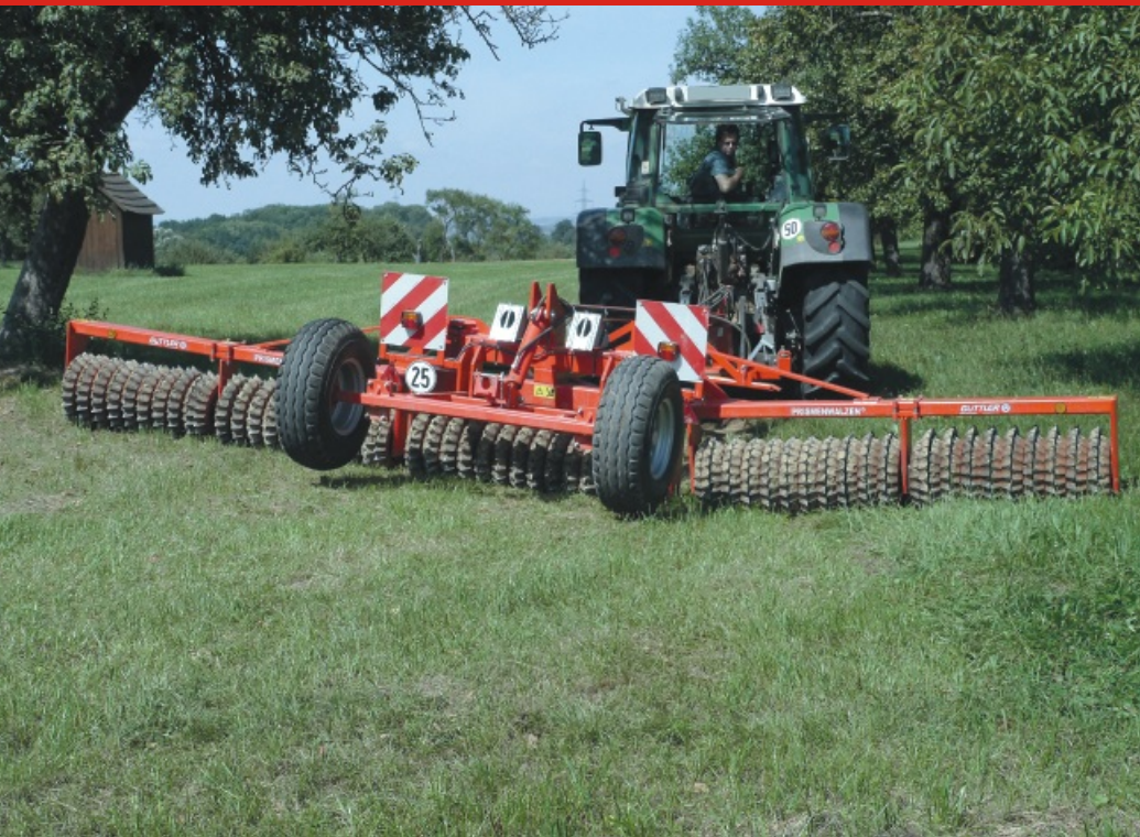
Mayor: driedelig frame - goede bodemaanpassing, werkbreedte 6,40 m / 7,70 m / 8,20 m
