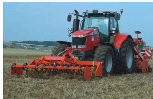
De steile tanden halen vrijwel geen stro naar boven
