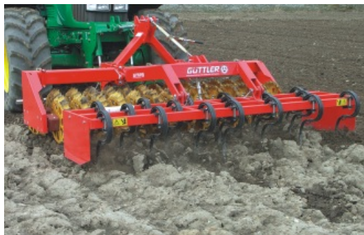
DUPLEX® 30-56, 959 kg met tandenvoorzetstuk 380 kg
