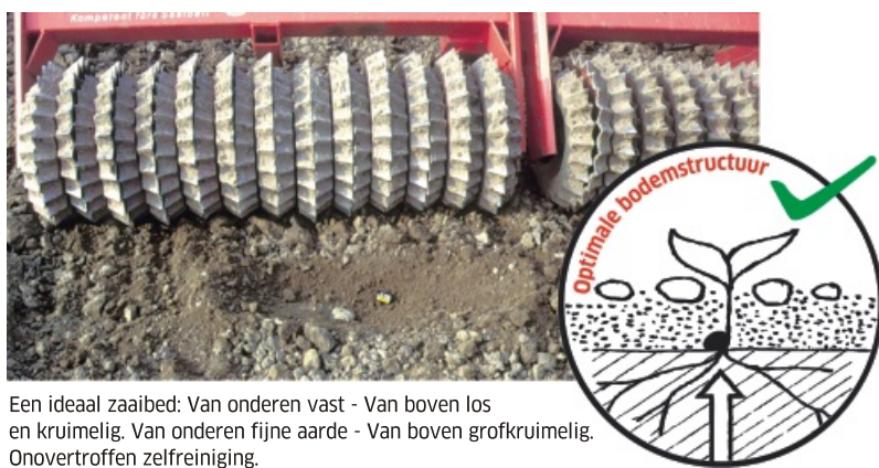
De eerste gepatenteerde Güttler-wals met \varnothing 32/35 cm
