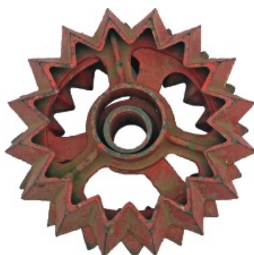
De eerste gepatenteerde Güttler-wals met \varnothing 32/35 cm
