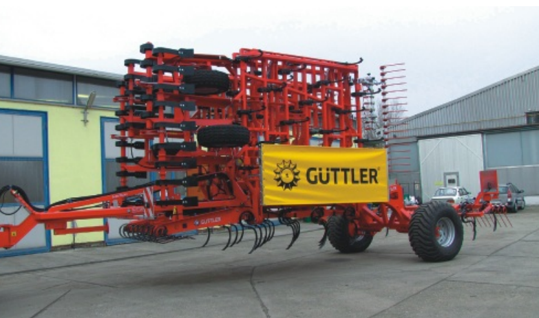
Transportbreedte 3 meter, standaard tandbescherming en beremming
