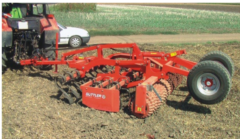
Feldmeister® LK 30 - Werkbreedte 3 meter - met FlatSpring om te egaliseren
