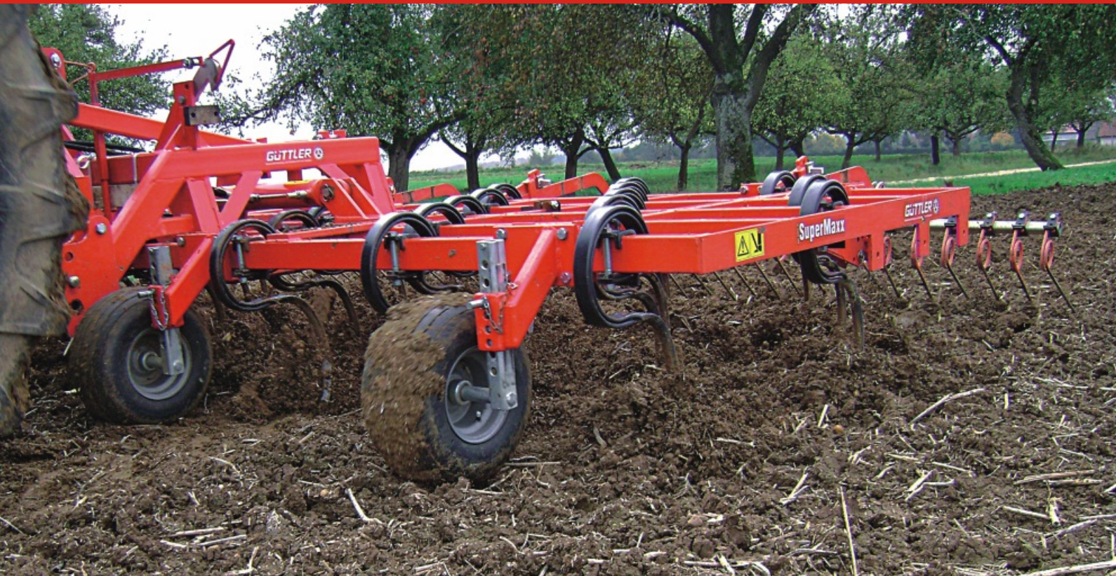
Diepteregeling via steunwielen voorop
