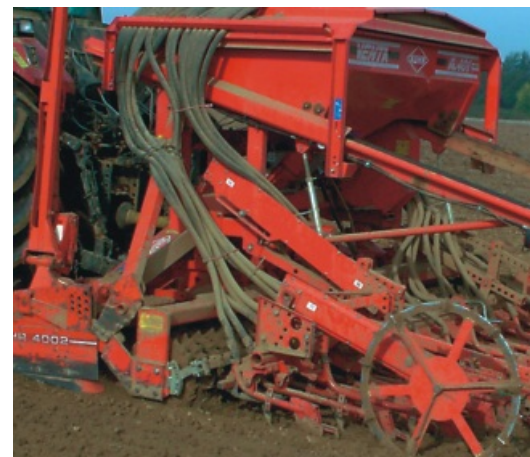
Simplex prismawals® Ø 45 cm gietijzer
