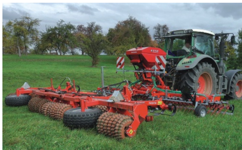
Offset®, in combinatie met HarroFlex wiedege en zaaiparaat
