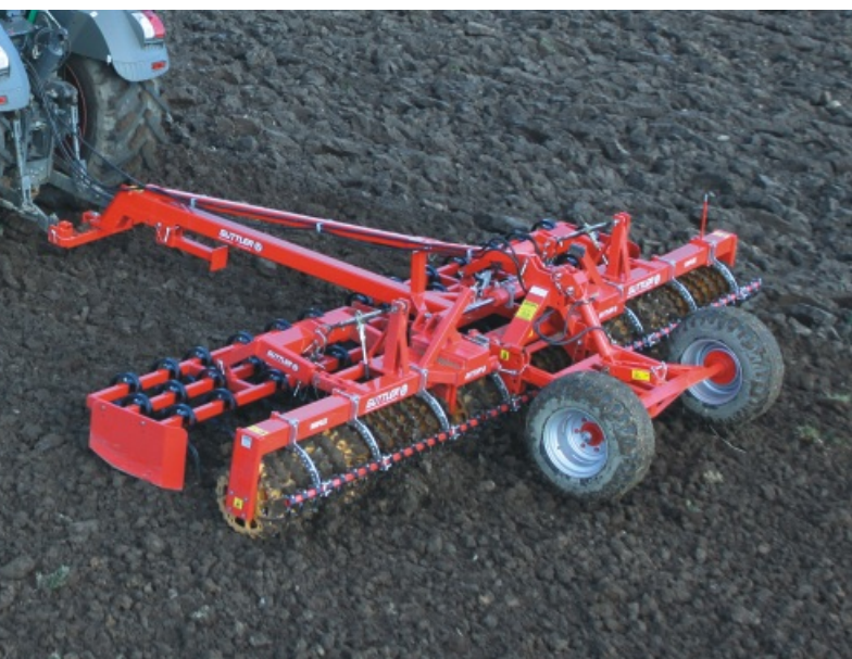
AVANT SX 610-56 U met treddissel en wielstel (op elk moment achteraf te monteren)
