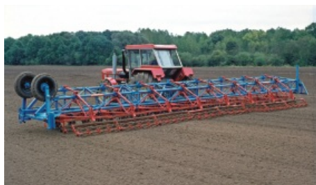
1975 : GAROMAT met dubbele verkrumelaar, met 12 m. werkbreedte destijds Europa's breedste zaaibedcombinatie!
