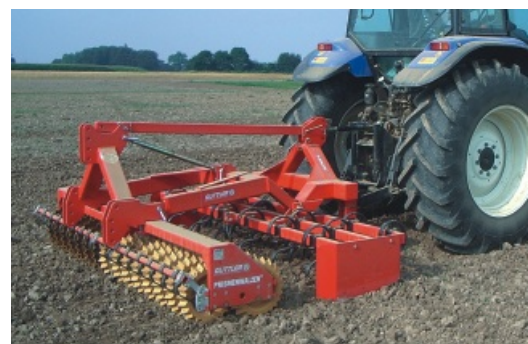
Met achter driepuntsbok voor zaaibedbereiding
