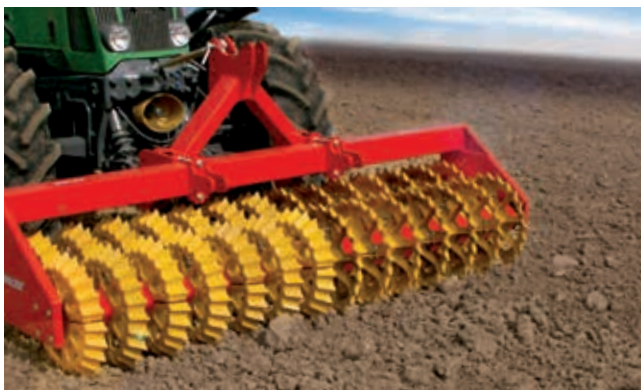
El rodillo de prismas® autolimpiante Duplex® da una estructura desmenuzada incluso a suelos arcillosos pesados.
