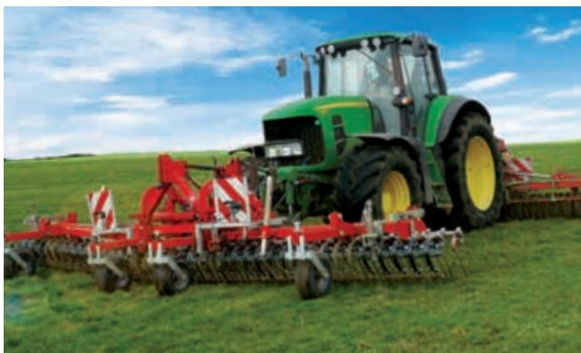
Greenmaster Alpin 600 - para tractores a partir de 100 CV. Ideal en espacios estrechos (zanjas, setos, vallas).
