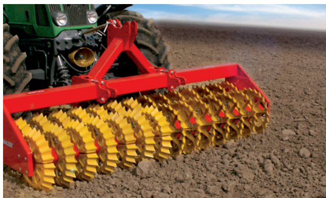
Le rouleau autonettoyant Duplex® Prismenwalzen® raffermi et émiette même les sols argileux et lourds.
