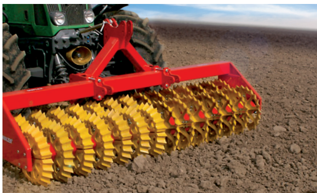
Le rouleau autonettoyant Duplex® Prismenwalzen® raffermir et émiette même les sols argileux et lourds.
