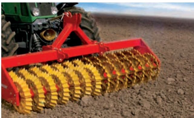
Die selbstreinigenden Duplex® Prismenwalzen® geben selbst schweren Tonböden eine lockere Krümelstruktur.
