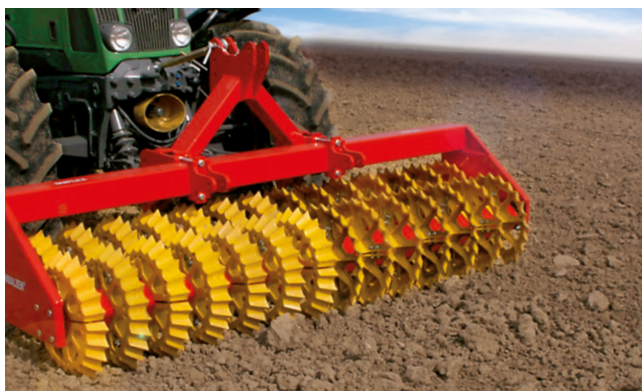
De zelfreinigende Duplex® Prismawalsen® geven zelfs zware klei-grond een losse kruimelstructuur.
