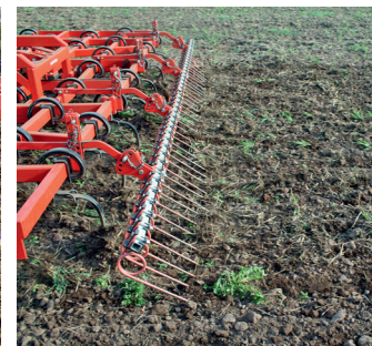
Die Zinken lösen den Bewuchs, der Striegel legt das Unkraut an der Oberfläche ab, so dass es vertrocknet.
