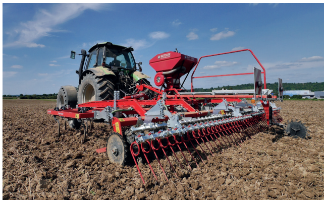
Mit Hilfe der optionalen Stützräder vorne lässt sich der Druck auf den Roll-Fix bei feuchten Böden reduzieren. Bodenschonend!
