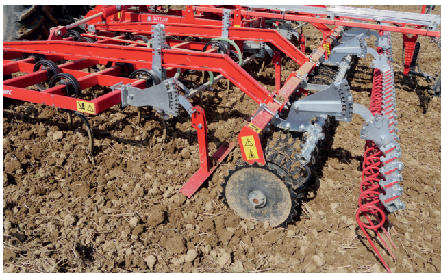
Option: Striegel nach der Walze zur mechanischen Unkrautbekämpfung.
