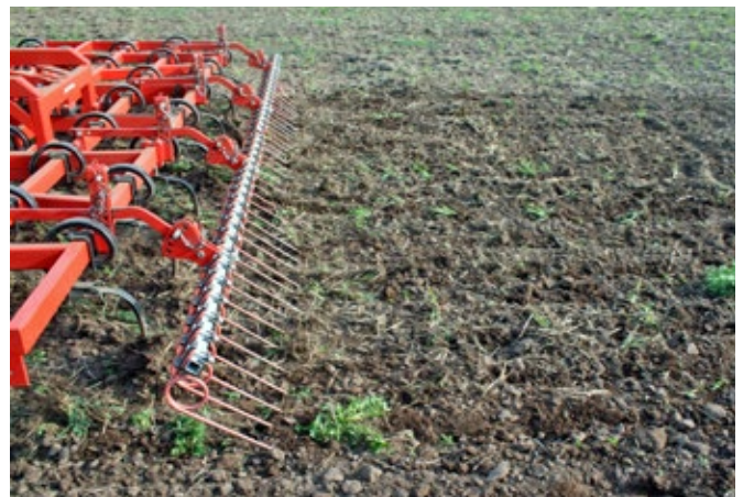
Die Zinken lösen den Bewuchs, der Striegel legt das Unkraut an der Oberfläche ab, so dass es verrocknet.
