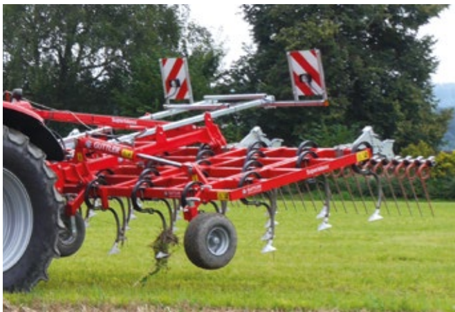
Leicht und wendig, auch für leichte Schlepper geeignet. Auf Wunsch: Gänsefuss-Schare 150 mm breit.
