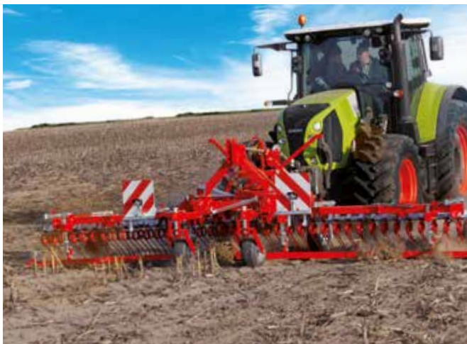
HarroFlex 600 lässt sich bei Bedarf auch im Frontanbau (ohne Sägerät) fahren. Kombiniert mit einer Matador-Walze wird er zu Greenmaster 600 alpin – eine schlagkräftige 5-in-1 Maschine für den Ganzjahreseinsatz.
