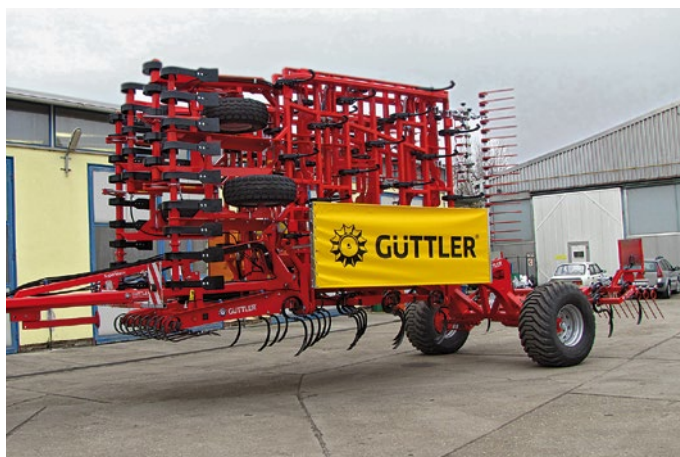
Largeur de transport de 3 mètres – protection latérale des dents au transport et frein à air de série
