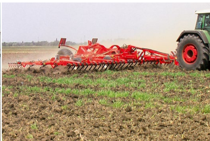
SuperMaxx® 1200 – préparation du lit de semences
