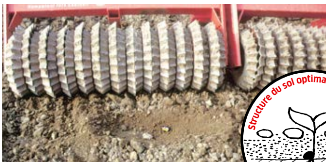
Un lit de semences idéal : Dessous ferme - dessus léger Fine terre en dessous, mottes au-dessus Autonettoyage inégalé
