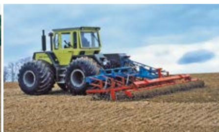
A partir de 1977 : La construction légère GAREC est remplacée par celle plus robuste du GAROMAT. Ce montage était très en avance sur son temps à l'époque (Photo : Daimler AG).
