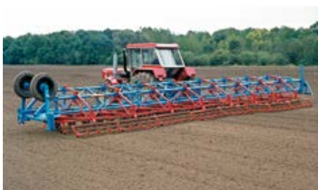
1975 : GAROMAT avec double rouleau émetteur et une largeur de travail de 12m - le plus grand combiné de semis d'Europe !
