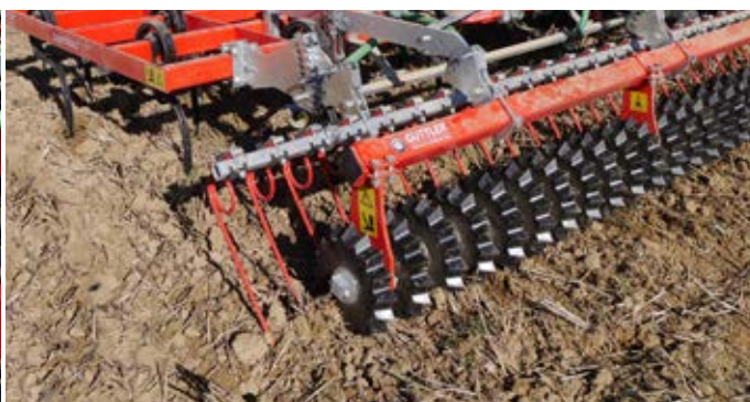
Peigne niveleur et rouleau RollFix pour une finition parfaite
