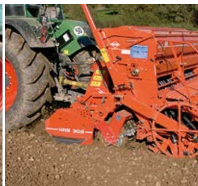
Rouleau prismatique Simplex ø 45 cm fonte aciérée
