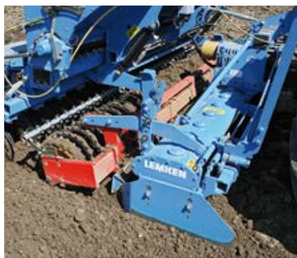
Rouleau prismatique Simplex ø 45 cm Synthetik Ultra
