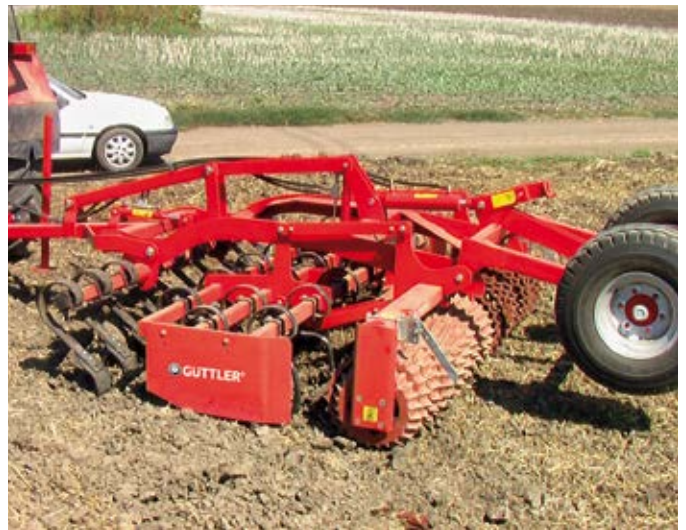
Feldmeister® LK 30 - Largeur de travail de 3 m - avec FlatSpring pour niveler
