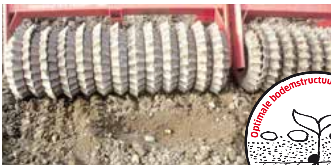
Een ideaal zaaibed: Van onderen vast - Van boven los en kruimelig. Van onderen fijne aarde - Van boven grofkruimelig. Onovertroffen zelfreiniging.
