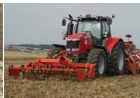
De steile tanden halen vrijwel geen stro naar boven
