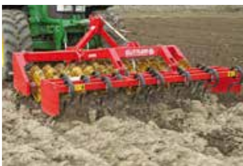
DUPLEX 30-56, 959 kg met tandenvoorzetstuk 380 kg
