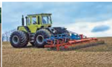
Vanaf 1977: De licht gebouwde GAREG werd afgelost door de GAROMAT, die beter paste bij de groeiende trekvermogens en zijn tijd ver vooruit was (Foto's: Daimler AG)
