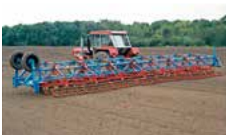
1975: GAROMAT met dubbele verkrumelaar, met 12 m. werkbreedte destijds Europa's breedste zaaibedcombinatie!
