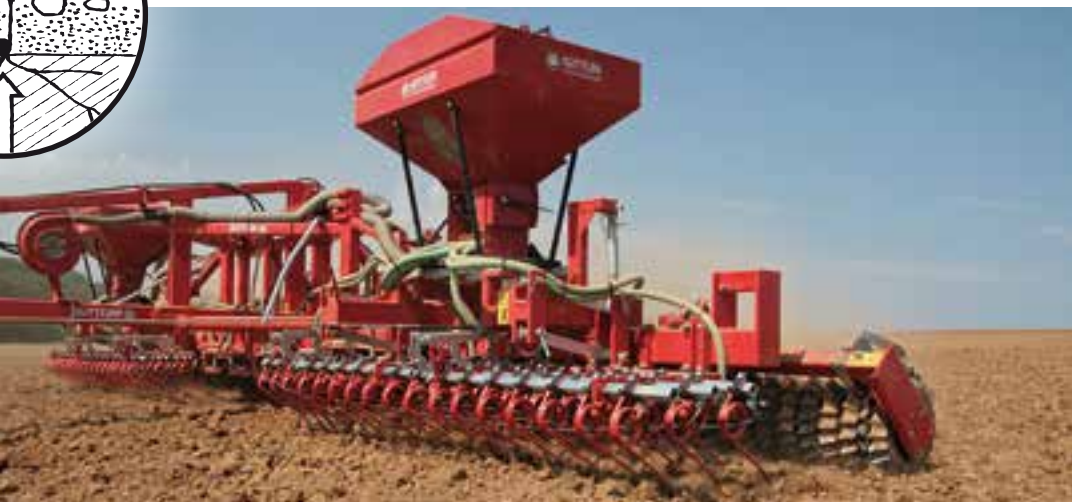
Alle getrokken walsen kunnen worden gecombineerd met Harroflex wiedegtanden.
