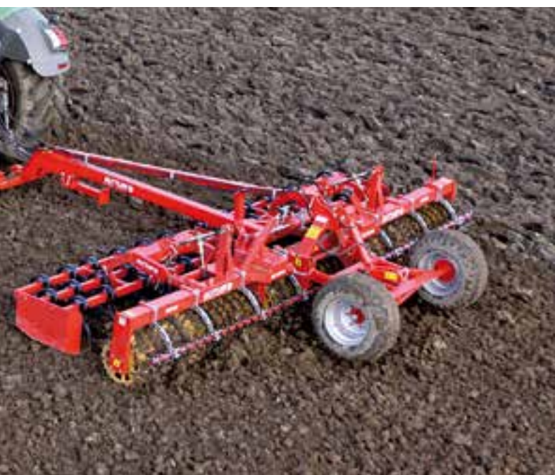
AVANT SX 61056 U met trekdissel en wielstel (op elk moment achteraf te monteren)
