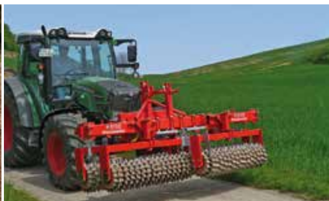
MEDIANA werkend in de front in plaats van een "dood" frontgewicht
