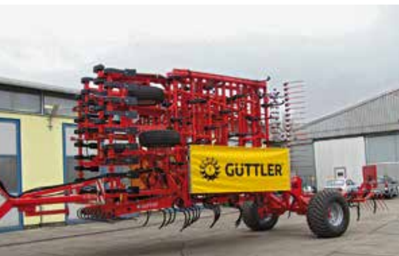
Transportbreedte 3 meter, standaard tandbescherming en beremming
