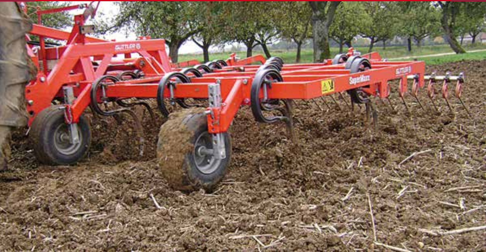
Diepteregeling via steunwielen voorop
