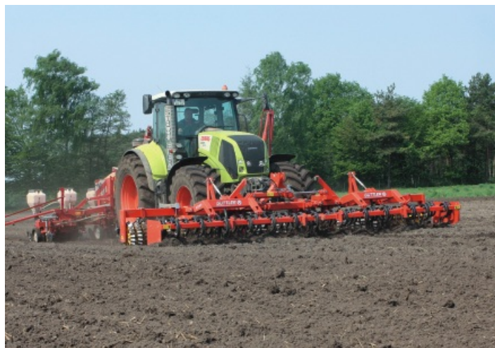
Avant 6 m mit Zinkenvorsatz zur Maissaat
