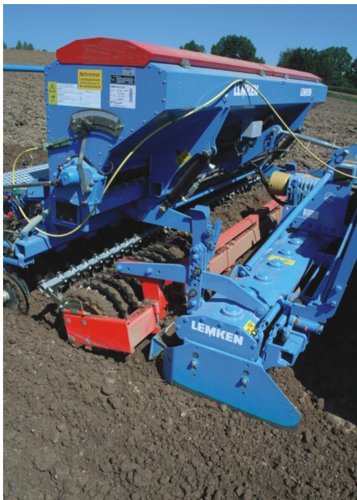
SX 41 (Durchmesser 45 cm) Synthetik Ultra mit Aufbaudrille, Arbeitsbreite 4,00 Meter
