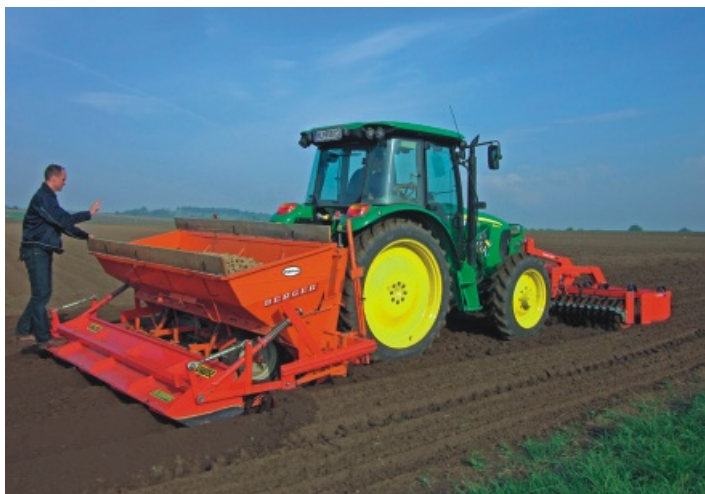
Avant mit Simplex 45 cm - Kartoffeln legen direkt in die raue Winterfurche
