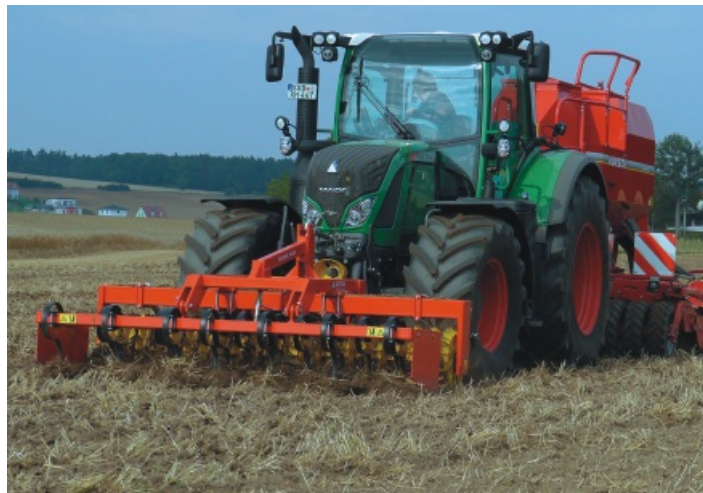
Avant mit SX 56 cm Durchmesser für hohe Geschwindigkeiten
