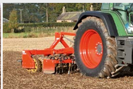
DX 30-56 z przystawką zębatą i wieżą trzypunktową do zaczepienia z tyłu do uprawy przedsiewnej
