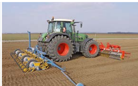
Avant SX 610-56 U z broną wyrównującą do buraków i rzepaku
