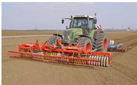
Avant SX 610-56 U z broną wyrównującą do uprawy przedsięwnej
