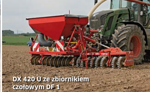
Z trzypunktową wieżą w zaczepieniu tylnym do uprawy przedsięwnej
