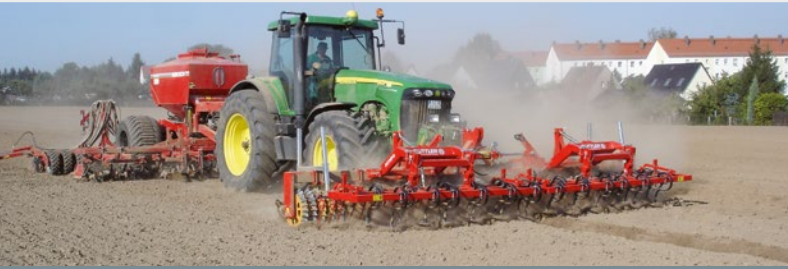
Auf schweren Böden mit Zinkvorsatz 3-balkig
