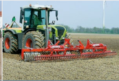
Auf leichten Böden mit Einebnungsstriegel
