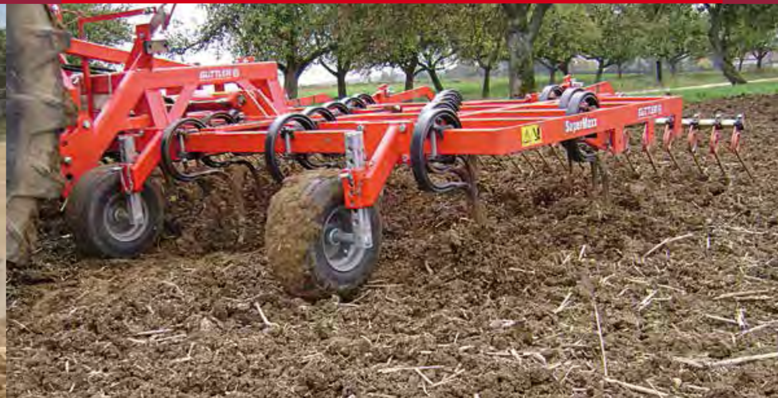
Tiefenführung über Stützräder vorne
