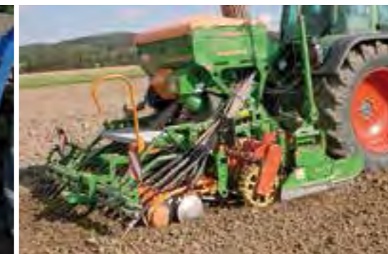
Simplex-Prismenwalzen ø 56 cm Synthetik Ultra
