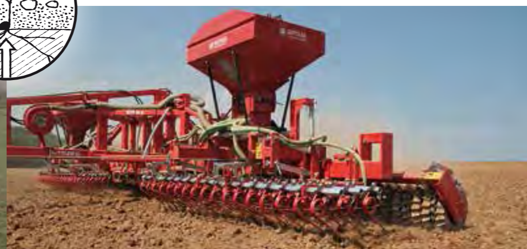
Alle Anhängewalzen können mit HarroFlex Striegeln kombiniert werden.
