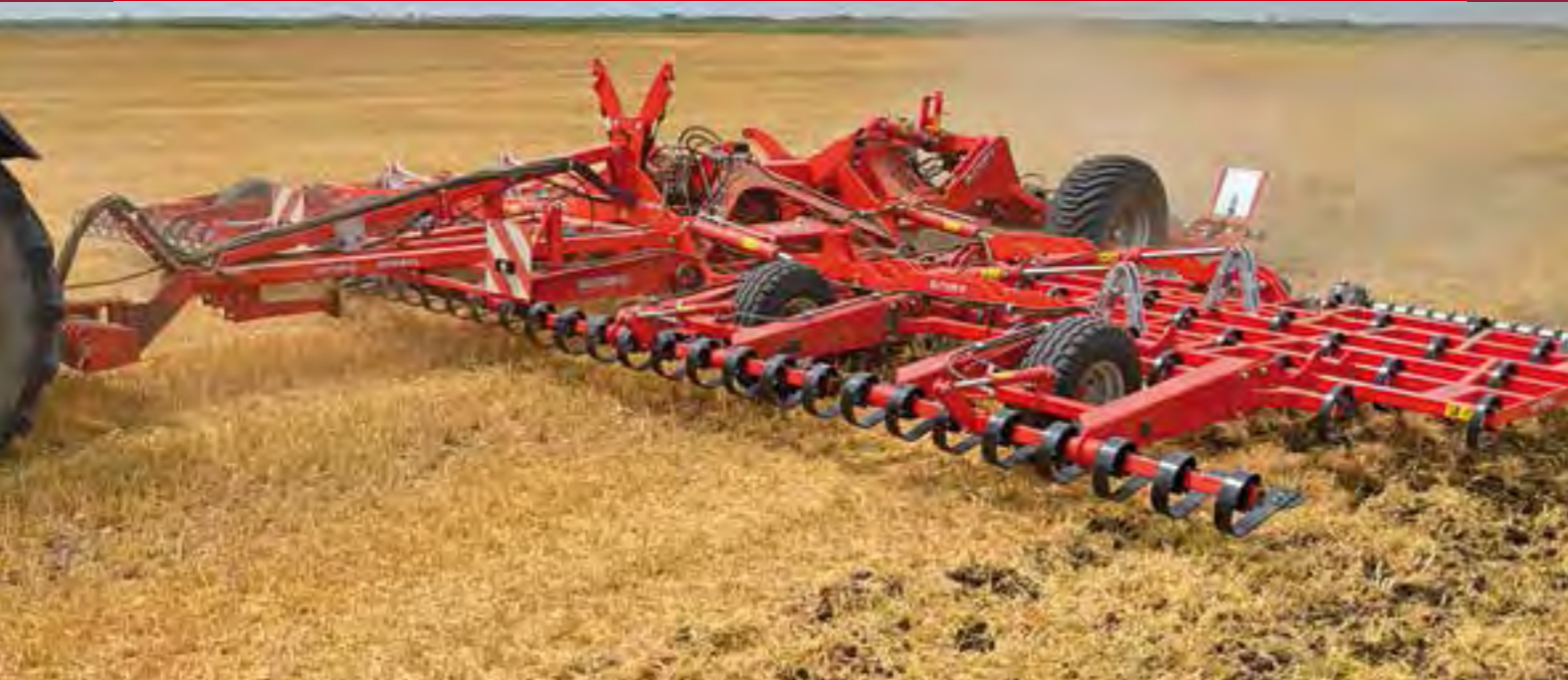
SuperMaxx® 1200 – flache leichtzügige Stoppelbearbeitung mit enormer Schlagkraft und geringem Spritverbrauch (ca. 5 Liter pro Hektar)
