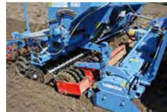
Simplex-Prismenwalzen ø 45 cm Synthetik Ultra
