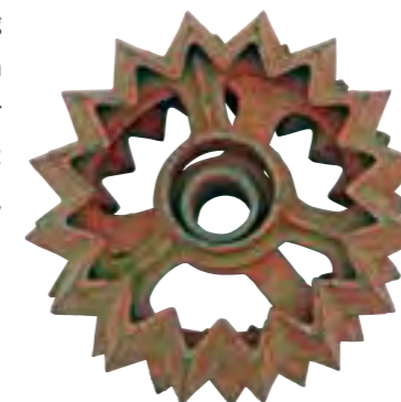
Die erste patentierte Güttler-Walze mit Ø 32/35 cm
