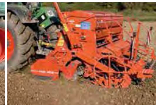
Simplex-Prismenwalzen ø 45 cm Sphäroguss
