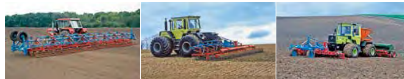
1975: GAROMAT mit Doppelkrümlern und 12 m Arbeitsbreite – damals die breiteste Saatbettkombination Europas!
