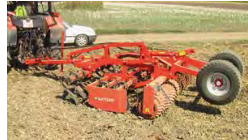
Feldmeister® LK 30 – Arbeitsbreite 3,0 Meter – mit FlatSpring zur Einebnung
