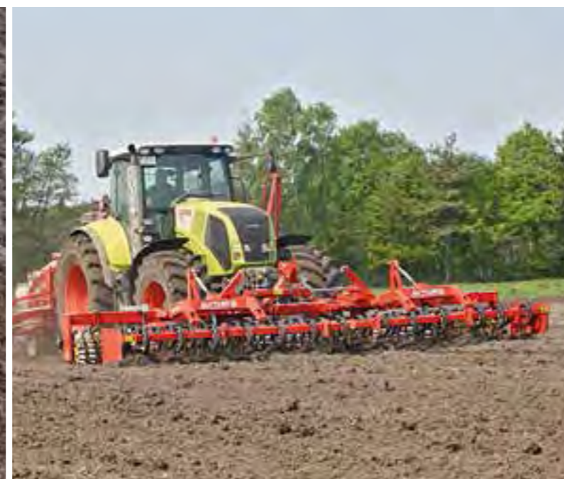
AVANT SX 610-56 U mit Zinkenvorsatz zur Maissaat
