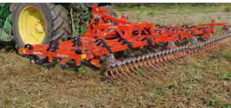
Unkräuter werden an der Oberfläche abgelegt und vertrocknen
