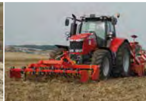
Steilstehende Zinken holen kaum Stroh nach oben
