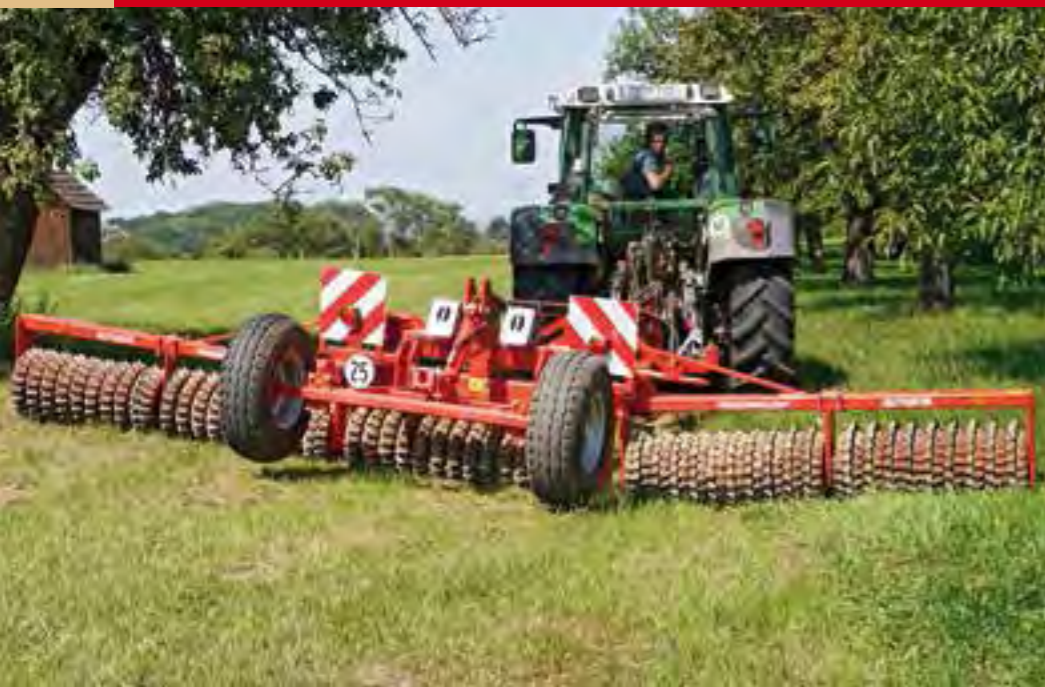
Mayor 640: Dreiteiliger Gelenkrahmen - gute Boden Anpassung
