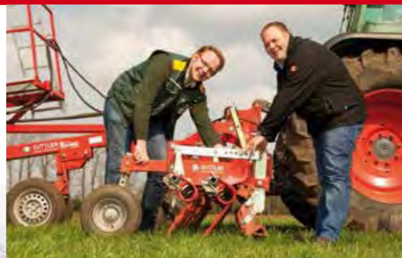
Einebnen, Striegeln, Säen und Anwalzen: In nur einer Überfahrt schafft der GreenMaster die perfekte Grünlanderneuerung
