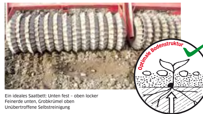
Die erste patentierte Güttler-Walze mit Ø 32/35 cm
