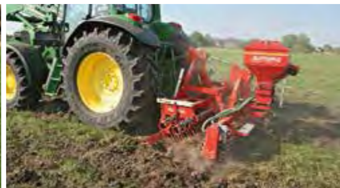
GreenMaster 300 zur Beseitigung von Wildschäden
