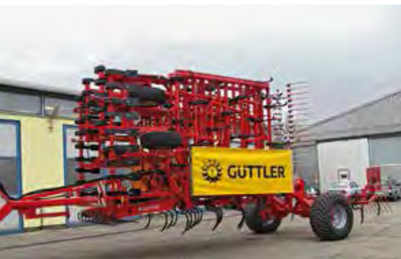
Transportbreite 3,00 Meter – Zinkenschutz und Druckluftbremse Serie
