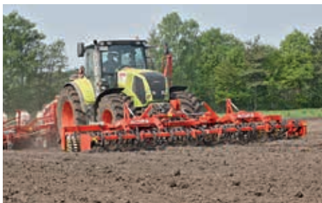
Avant SX 610-56 U mit Zinkenvorsatz zur Maissaat
