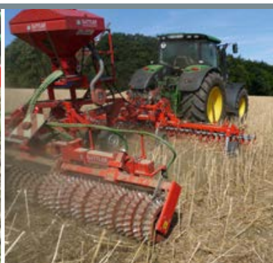
Green Master 640 direkt auf Rapsstoppel: Ausfallraps vollständig zum Auflaufen bringen; anschließend Stoppelbearbeitung mit dem Guttler SuperMaxx®
