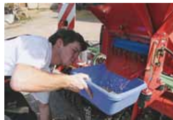
Das Abdrehen des pneumatischen Nachsägeräts geht bequem. Links und rechts werden Saatmenge und Abstand der Abstreifer eingestellt. Es besteht die Möglichkeit Restmengen abzulassen.
