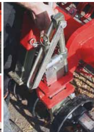
Die Arbeitseigenschaften des Striegels und auch des Ripperboards lassen sich werkzeuglos mit wenigen Handgriffen einstellen. Über den Dreipunkt kann das Gewicht der Prismenwalze bei Bedarf auch auf das Striegelfeld gezogen werden.
