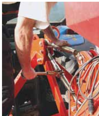
Die Arbeitseigenschaften des Striegels und auch des Ripperboards lassen sich werkzeuglos mit wenigen Handgriffen einstellen. Über den Dreipunkt kann das Gewicht der Prismenwalze bei Bedarf auch auf das Striegelfeld gezogen werden.
