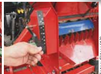
Das Abdrehen des pneumatischen Nachsägeräts geht bequem. Links und rechts werden Saatmenge und Abstand der Abstreifer eingestellt. Es besteht die Möglichkeit Restmengen abzulassen.
