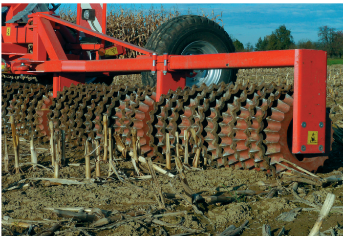
Links: Durch ihre gute Bodenangepassung quetscht die Prismenwalze von Güttler die Mais-Stoppeln. Diese zerfallen dann über den Winter und der Schädling erfriert ohne diesen Schutz.
