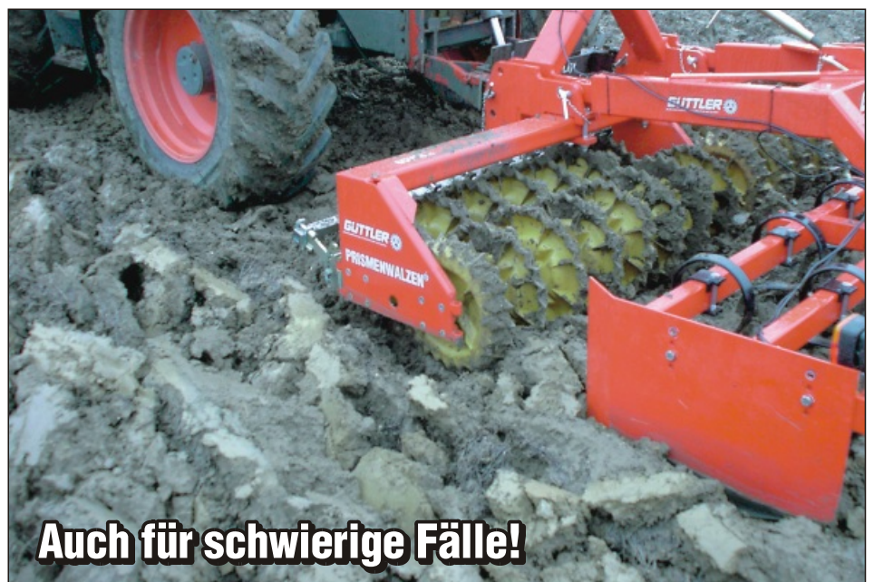
Unübertroffene Selbstreinigung. Für Extremfälle lassen sich Ausräumer nachrüsten.
