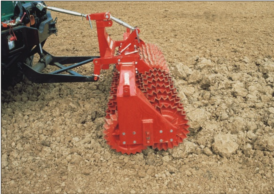
Duplex® Ø 450 mm - drückende Fronthydraulik - knackt die Kluten auf der ganzen Fläche und nicht nur streifenweise
