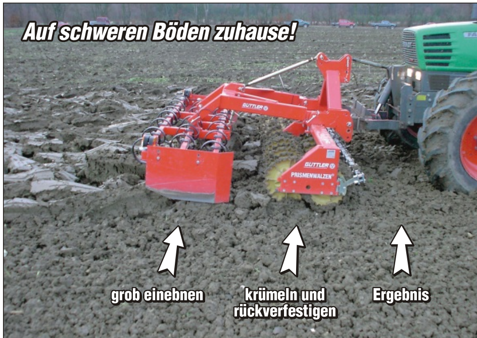
Duplex® Ø 450 mm, mit Zinkenvorsatz - die Zinken ebnen die großen Schollen grob ein, effektiveres Arbeiten.
