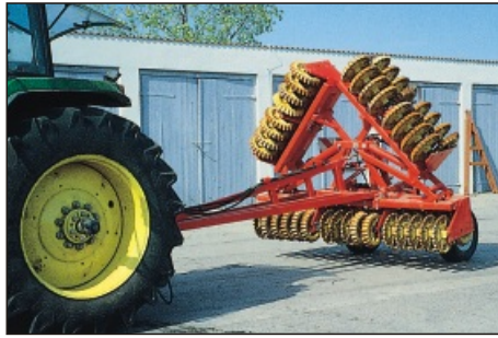
... Fahrwerk zum Anstecken, Transportbreite 3 Meter.
